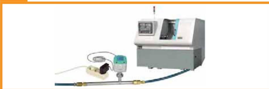
Mit Schnellkupplungen lässt sich der Verbrauchszähler schnell in den Zuleitungsschlauch vor einer Maschine integrieren. Bei Stillstand der Maschine kann die Leckrate ermittelt werden, bei laufender Maschine deren Momentanverbrauch. Die Stromversorgung erfolgt über die Steckdose mit dem Steckernetzteil. Zur Datenaufzeichnung über einen längeren Zeitraum empfiehlt sich der Einsatz des DS 400 mobil.
