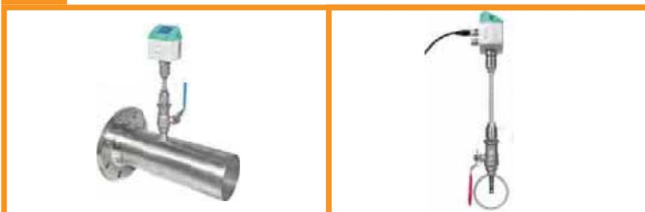
Für Rohrdurchmesser von 2" bis DN 300 steht der bewährte Verbrauchssensor VA 500 zur Verfügung. Sein konstruktiv durchdachter Aufbau ermöglicht den Einbau auch unter Druck in Rohre mit Nennweiten DN 300. Der Einbau erfolgt durch einen handelsüblichen 1/2" Kugelhahn.
